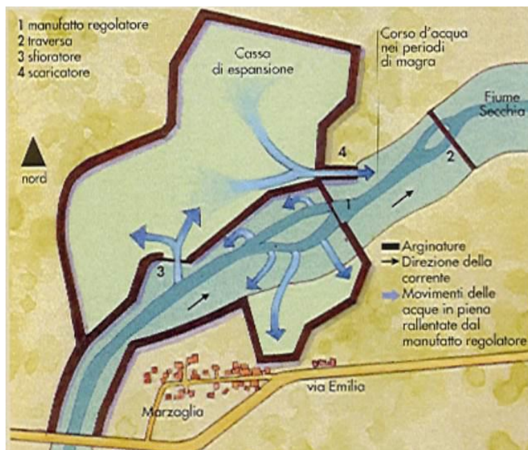
Figura 2: Schema di funzionamento della Cassa del Secchia.
