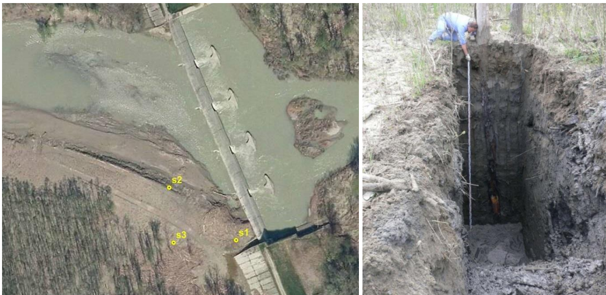
Figura 96: Aree di localizzazione dei 3 scavi esplorativi all'interno della cassa in linea svolti nel 2016 (a sinistra) e scavo esplorativo n. 3 all'interno della cassa in linea (a destra).
