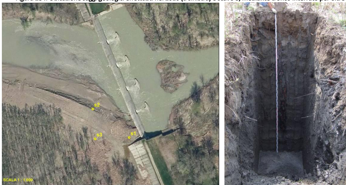
Figura 284: Ubicazione saggi geologici effettuati nel 2016 (a sinistra) e scavo 3, mediante tronco interrato per oltre 5 m (a destra).
