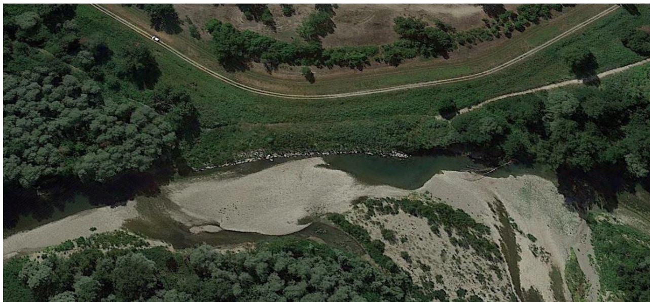
Figura 94: Vista aerea (da Google Earth) dell'erosione della sponda destra del fiume Secchia in un tratto in cui l'argine della cassa d'espansione è praticamente in frodo.
